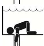
**Coincement Mécanique** - Des bijoux, des maillots de bain, des décorations pour les cheveux, des doigts de la main et des pieds ou des phalanges peuvent potentiellement être coincés dans le couvercle d'une buse d'aspiration, entraînant un coincement mécanique.
