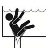
**Éviscération / Éventrement** - Une pression négative appliquée directement sur les intestins à travers la buse d'un puits d'aspiration ou à travers le couvercle d'une buse d'aspiration endommagée, cassée, fissurée, absente ou mal fixée peut entraîner une éviscération / un éventrement.
