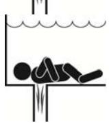
**Atrapamiento extremidades** - Una extremidad introducida en la apertura de una boca de aspiración de un pozo o en la tapa de una boca de aspiración dañada, rota, agrietada, ausente o no fijada correctamente puede producir un vínculo mecánico o el hinchamiento de la extremidad misma.
